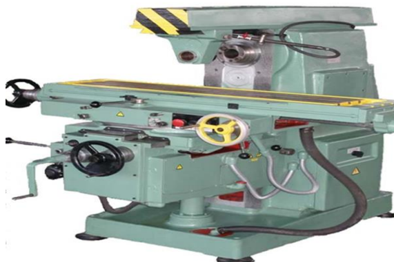
Рисунок 3 – станок горизонтально – фрезерный 6Р82Г [10]
